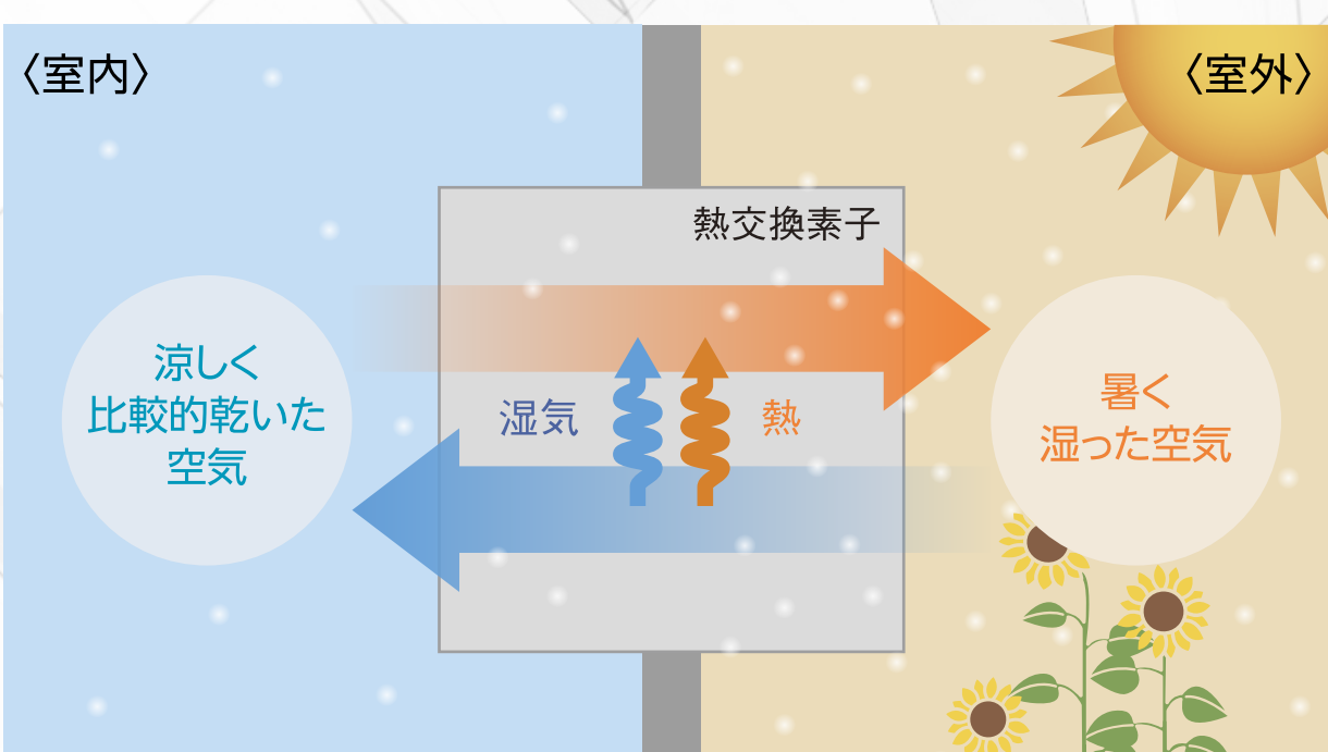
熱交換器の基本原理イメージ図
